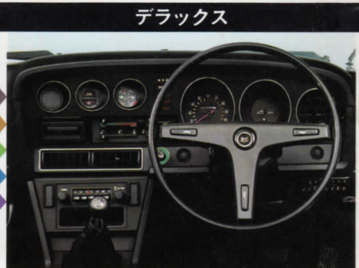
油圧ランプ チャージランプ。シガレットライターつき。
